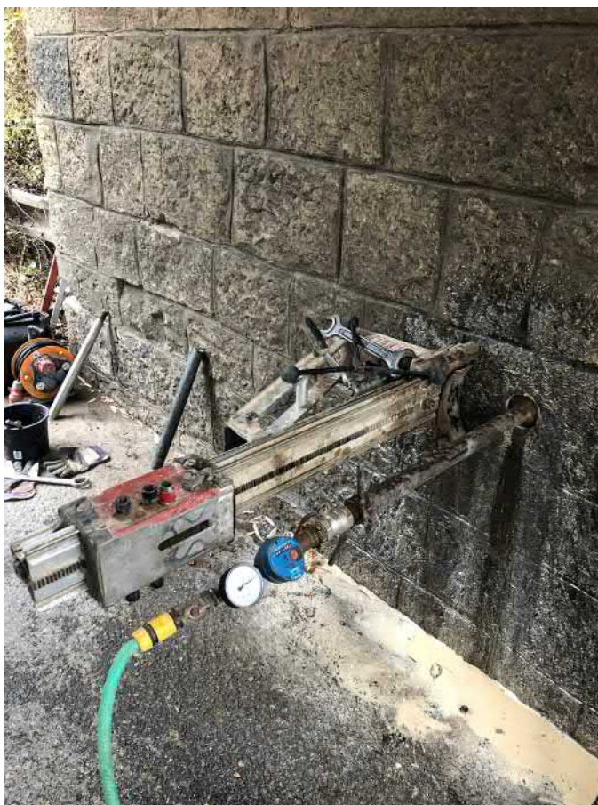
Fotografie č. 1: Vodní tlaková zkouška ve vrtu V1 (opěra směr Brno hl. n.)
